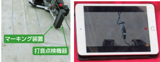
壁昇降点検ロボットイメージ
